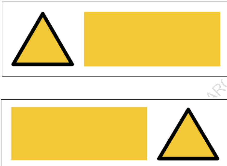
**FIGURA 10 - Diseño para un cartel de seguridad con la información adicional a la derecha y a la izquierda de la señal de seguridad**
